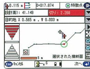
▲道路の丁張り・杭打ち
